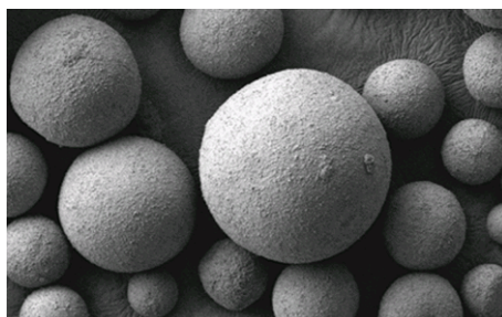
Рисунок 1. Частицы AEROPERL® 300 Pharma в сканирующем электронном микроскопе
